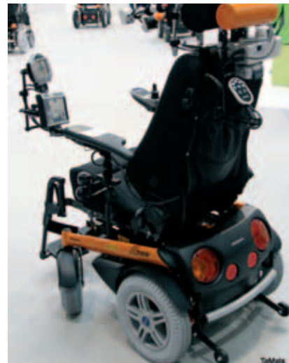
Električni invalidski voziček proizvajalca Ottobock s specialno komando z vsemi dodatki (kamera, joystick v vzglavniku,...).
