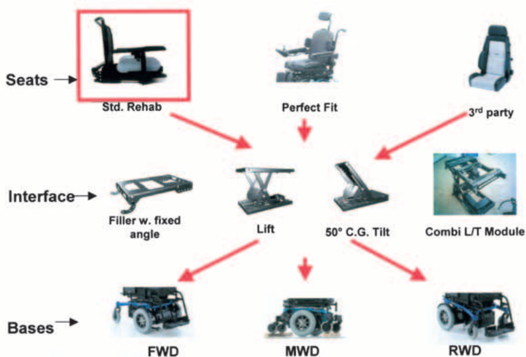
Osnovni sestavni moduli na tri tipske izvedbe električnega invalidskega vozička Groove
