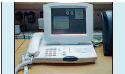
TuxScreen, ki poganja TinyX, twm in SIP VoIP aplikacijo (teče na Debian ARM Linux okolju povezan s kartico PCMCIA HDD).
