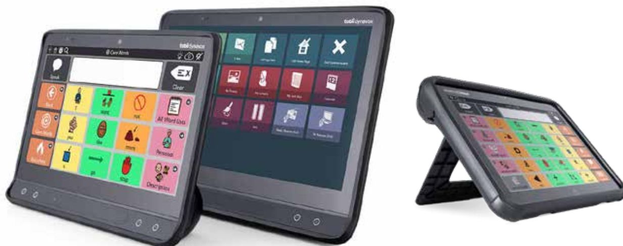
Primeri dveh komunikatorjev (levo, manjši I13 in večji I16), ki ju lahko upravljamo z očmi in primer komunikatorja, ki se lahko upravlja preko zaslona na dotik (desno, i-110), vir slik: https://www.tobiidynavox.com/ .
