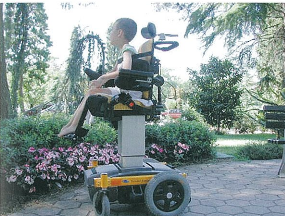
Slika 8: Električni dvig sedežne enote: omogoča boljše funkcijske sposobnosti, boljše komunikacijo, pogled iz oči v oči, boljše psihološko počutje, večjo samozavest.
