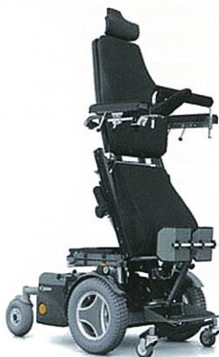
Slika 3: Električni voziček, ki omogoča postavljanje v stoječ položaj.
