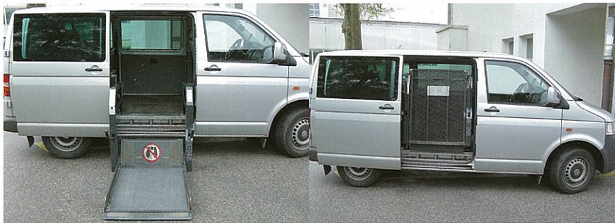
Slika 46: Kombi z vgrajenim dvigalom; ko dvigalo ni v uporabi, je v pokončnem položaju zloženo v notranjosti kombija.
