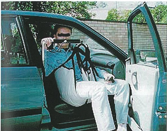
Slika 45: Dvigalo za presedanje invalida z vozička na avtomobilski sedež in obratno.
