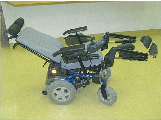
Slika 7: Električni nagib sedežne enote, posebej hrbtnega naslona in posebej podnožnikov omogoča počitek, razbremenitev stalno obremenjenih delov telesa, boljše funkcijske sposobnosti, manj bolečin pri sedenju, boljše delovanje notranjih organov in preprečuje oziroma zmanjšuje otekanje nog.
