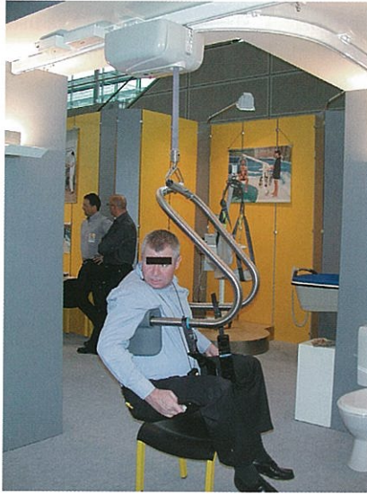
Slika 34: Način vpenjanja in dvigovanja s posebnim lokom, ki omogoča hitro in enostavno vpenjanje in dvigovanje in poleg tega (v primeru, da ne uporabimo nosilcev za nogi) še oblačenje hlač med tem ko je distrofik dvignjen.
