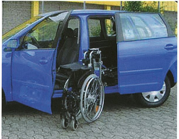
Slika 43: Dvigalo za dvig navadnega vozička v avto; zadnja vrata avtomobila so drsna.
