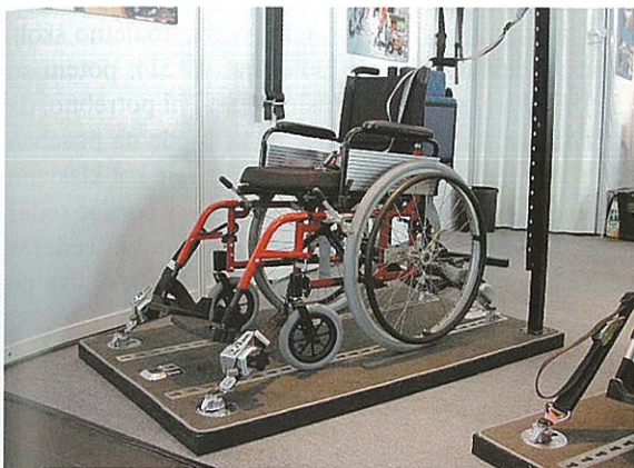
Slika 49: Sistemi za pritrditev vozička v avtomobilu. Na avtomobilski pod so montirani posebni nosilci z utori, kamor se zataknejo napenjalci. Voziček mora biti pričvrščen spredaj in zadaj, na levi in desni strani. Potrebni so še pasovi za stabilen položaj invalida.
