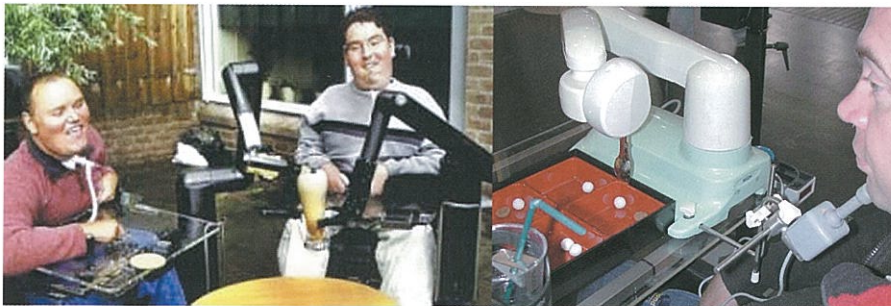
Slika 66: Elektronski pripomoček za hranjenje (roka robot), ki ga lahko upravljamo s prstom roke ali z brado.
