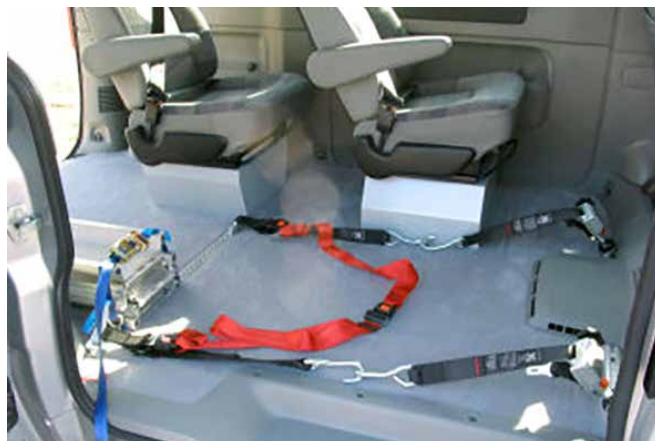
Varnostni pasovi za pritrditev invalidskega vozička (Foto arhiv društva)
