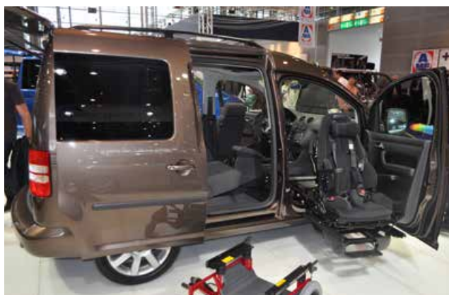
VW Caddy opremljen z vrtljivim sedežem
